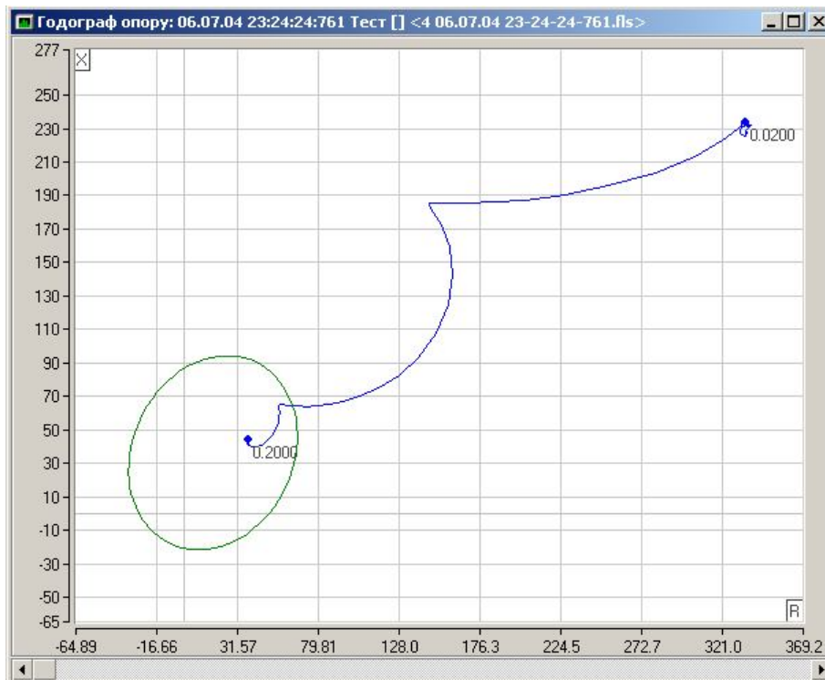
Рис. 9.23. Приклад побудови годографа опоры під час однофазного к.з. на лінії
